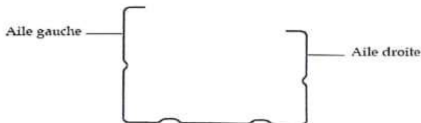
Figure 1 : Coupe transversale d'un montant 70
