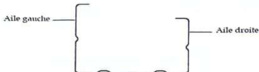
Figure 1 : Coupe transversale d'un montant 70
